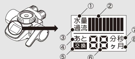
**注意** 交換サインが点滅する前に電池を交換しますと流量計がリセットされ、適切な交換時期をお知らせすることが出来なくなります。電池の交換は必ずカートリッジ交換と同時に行ってください。
