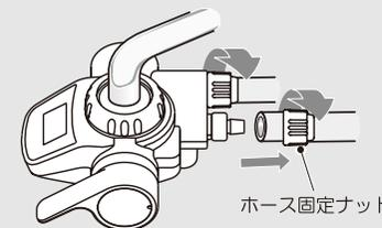
※ホースが抜けにくい場合には、切替コックを水栓から一度はずし、ホースを斜め方向に曲げることを繰り返してください。
