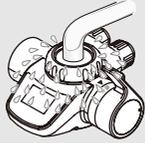
切替コックの上部から水が漏れる                                     | ① 取り付けが不十分                                        | ●切替コックのゴムパッキンと蛇口が垂直になるように取り付け直してください。                |
