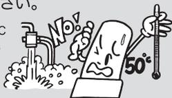
**4** 元止め式の瞬間湯沸器や元止め式の電気温水器のついている水栓には接続しないでください。
